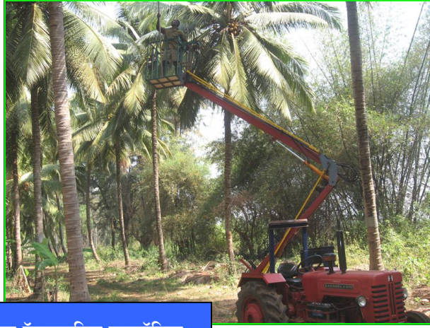
कोकण ट्रॅक्टरचलित हायड्रॉलिक इलिव्हेटरद्वारे फळकाढणी यंत्र
